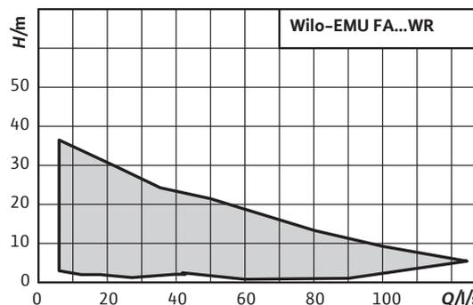
Характеристики согласно ISO 9906, приложение А. Указанный коэффициент полезного действия соответствует гидравлическому коэффициенту полезного действия.
