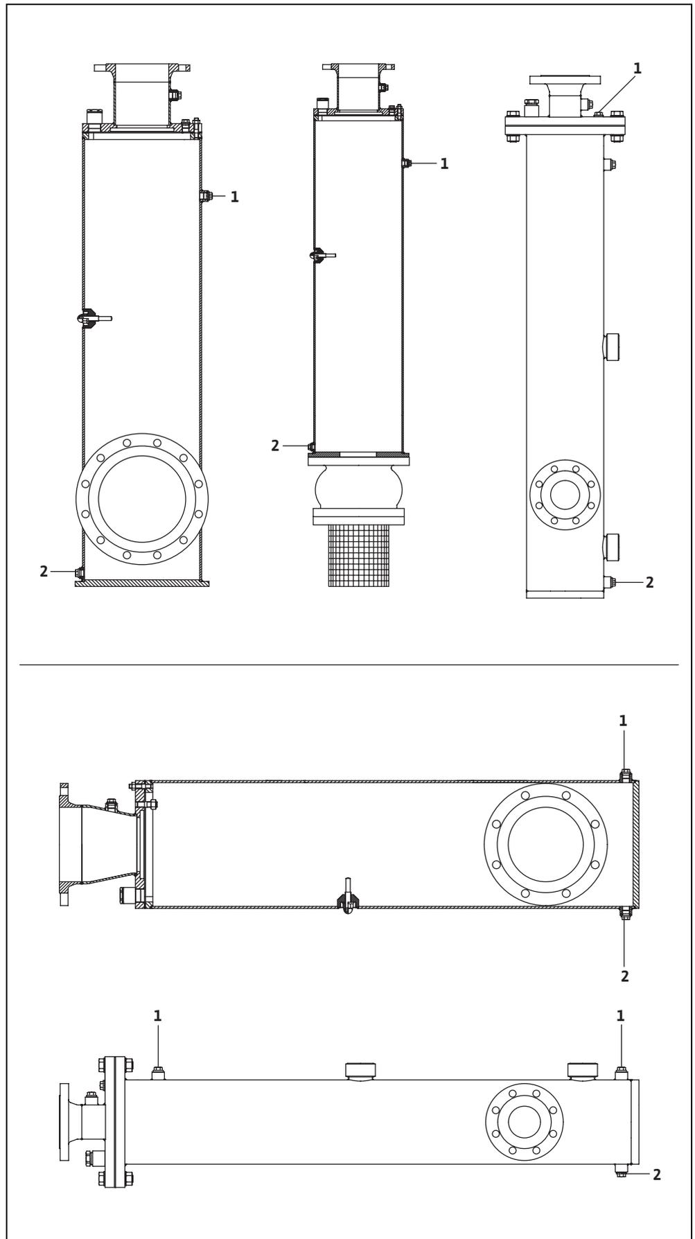
Рис. 5-6: Заливка и опорожнение напорного кожуха
