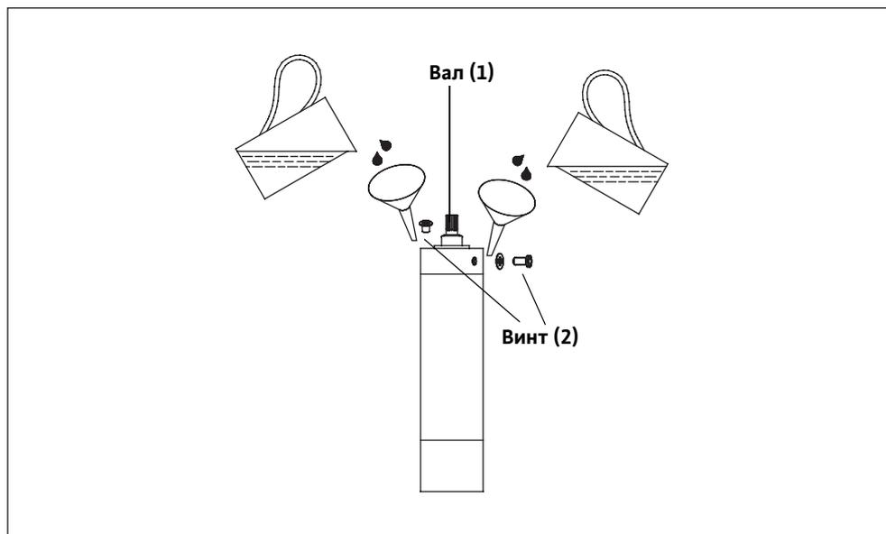
Рис. С-1: Заполнение двигателя
