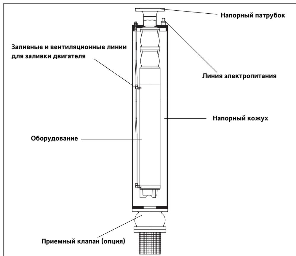
Рис. 3-1: Конструкция оборудования
