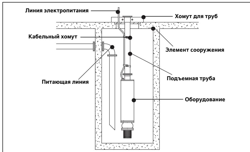
Рис. 5-5: Пример монтажа
